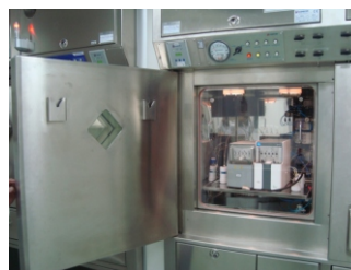
Figure 9a. Synthera module.
